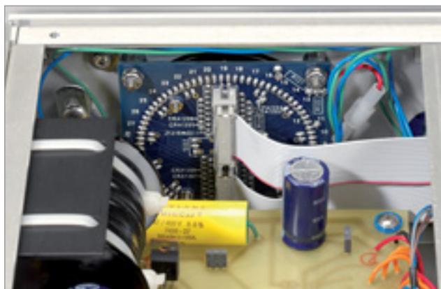
Kreisförmig angeordnete LEDs visualisieren bei der Vorstufe den aktuellen Pegel
