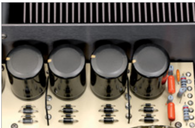
Im Netzteil verwendet Hovland Schottky-Dioden und schnelle Elkos
