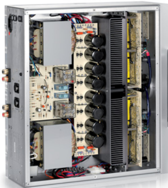
Ab dem Netzschalter ist die Endstufe strikt kanalgetrennt aufgebaut
