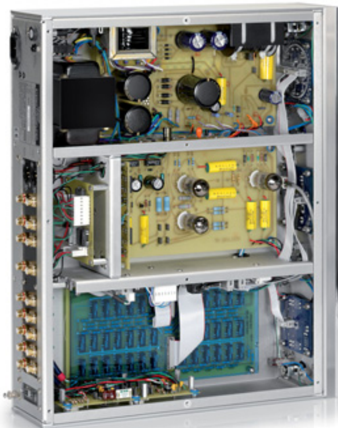
Netzteil, Line-Stufe und Pegelregelung sitzen in getrennten Kammern der HP-200
