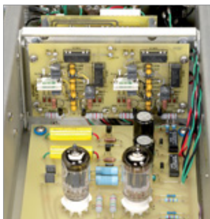
Nach der Line-Stufe wird das Signal mit Halbleitern symmetriert
